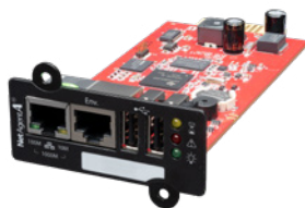
Карта SNMP с подключением датчика окружающей среды
